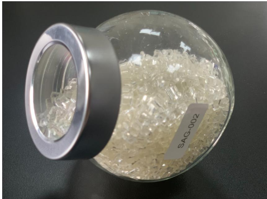
应用在回收废话旧塑料。利用相容剂回收废旧塑料，使之成为新的塑料合金或新的改性塑料，是“废物综合利用”比较好的可行办法，并可解决“白色污染”问题，具有很大的社会效益和企业经济效益。在国外已有很多先例，如荷兰国家矿业公司生产的BENNET相容剂，就是用于回收废旧塑料再生的专业使用相容剂，可以把两种或多种不同品种、不同性质的旧塑料，如聚烯烃塑料与工程塑料的边角料的共混再生，添加5%-10%相容剂作为海相或岛相之间的界面层，发挥相容剂的键合力极性相容基团效率，而制备成为一种新的塑料合金或改性塑料。上海佳易容聚合物相容剂诚信经营。浙江相容剂
