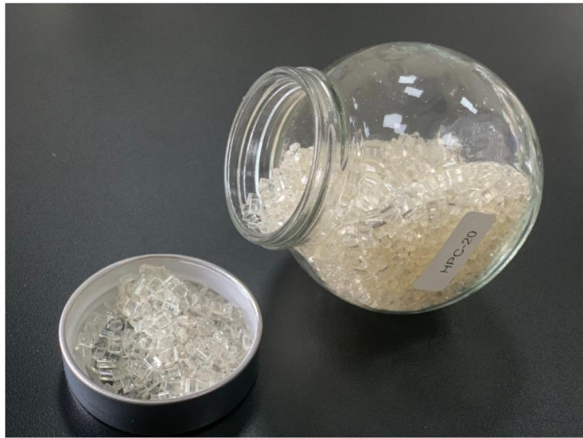
相容剂的性能：所谓相容剂在热力学本质上可以理解为界面活性剂，但在高分子合金体系中使用的相容剂一般具有较高的分子量，在不相容的高分子体系中添加相容剂并在一定温度下经混合混炼后，相容剂将被局限在两种高分子之间的界面上，起到降低界面张力、增加界面层厚度、降低分散粒子尺寸的作用，使体系之后形成具有宏观均匀微观相分离特征的热力学稳定的相态结构。相容剂的分类：由于相容剂对高分子合金体系的混合性和稳定性会产生重要的影响，因此，相容剂的合理选择和使用对高分子合金技术的实现是至关重要的。根据相容剂的基体高分子之间的作用特征，相容剂可分为两类，即非反应型相容剂和反应型相容剂。
