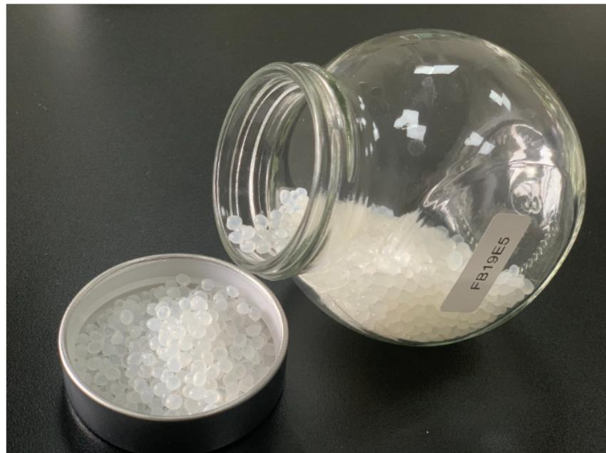
相容剂应用于塑料合金·Compatibilizer used in plastic alloy··相容剂的出现主要是为高分子材料合金技术服务的。所谓高分子合金, 即由两种或两种以上具有不同性质的高分子材料经共混并采用相应的相容化技术而得到的多相多组分体系, 而这样的高分子合金、共混、改性的重要关键材料就是相容剂。相容剂对合金技术的微观相态结构起到很好的调整和控制作用, 从而使共混材料实现高性能化和功能化的效果。相容剂广泛应用
